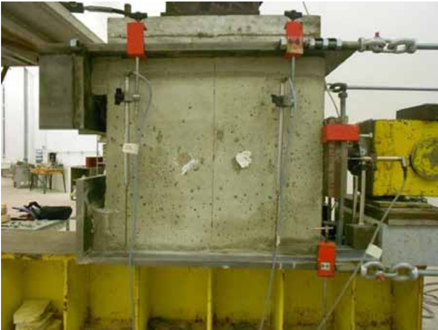
Il provino con intonaco strutturale, strumentato per la prova di "taglio" nel laboratorio dell'Università dell'Aquila
