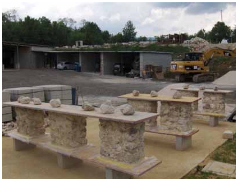
Nella foto alcuni dei provini ricostruiti riproducendo, in composizione morfologica e materica, la tipica muratura storica aquilana
