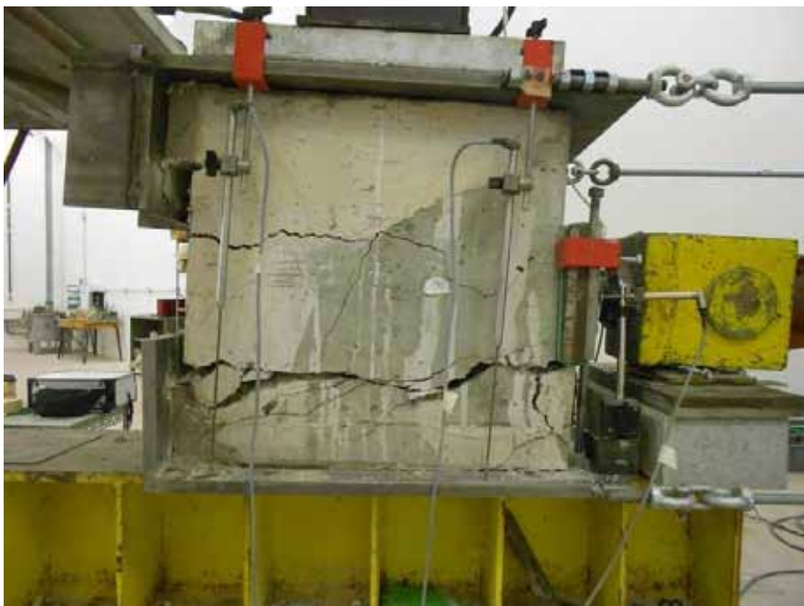
Rottura del muretto per “taglio”
