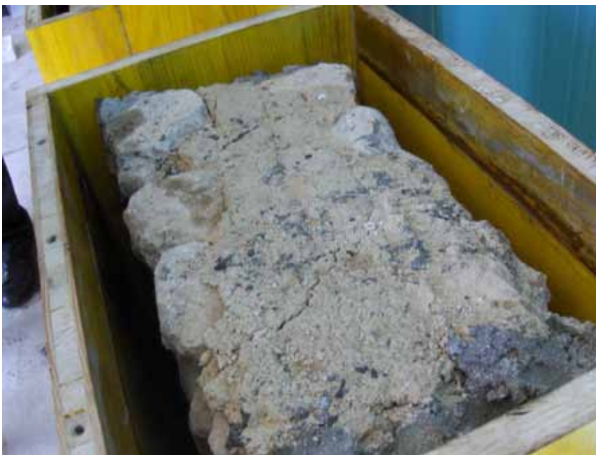
La cassaforma e preparazione dei muretti da rinforzare con intonaco di malta strutturale messa a punto in collaborazione con i tecnici del CTG
