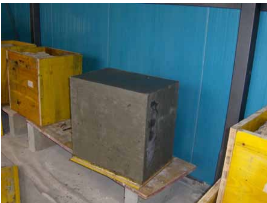
Uno dei provini “rinforzati” in fase di maturazione
