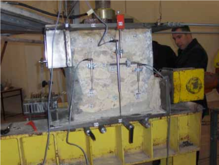
Prova su muretto rinforzato con sole "iniezioni" con malte additivate
